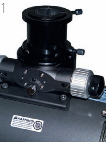
Le tube allonge du porte oculaire est vu ici en position sortie. Il présente un jeu important, préjudiciable à la photographie du ciel profond.
