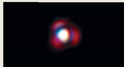
Sur banc optique, l'aspect de l'étoile artificielle est moins flatteur qu'avec le triplet apo. La dispersion d'énergie dans le premier anneau est plus importante et une aberration en forme de trèfle est perceptible.
